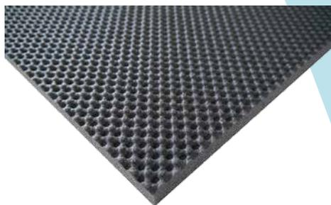
Der Kreisstrukturschaum wird für akustische Massnahmen eingesetzt und wirkt vor allem bei niedrigen Frequenzen. Durch die thermische oder plastische Oberflächenbearbeitung wird der Polyes-terschaum weitestgehend gegen Feuchtigkeit und Abrieb geschützt. Das Ein-
